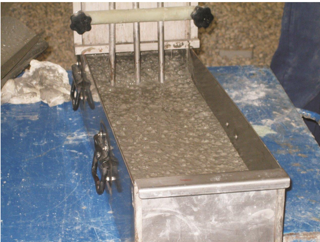
Calcestruzzo autocompattante, misura della fluidità
