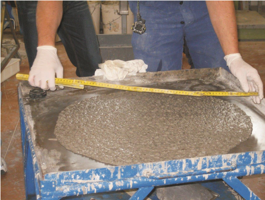
Calcestruzzo autocompattante, misura dello slump-flow
